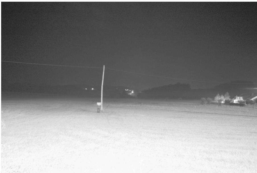
Slika 13: V vasi Zbure je svetlobno onesnaženje tako veliko, da je mogoče sredi travnika, ki je 150 m oddaljen od osvetljene ceste, brati časopis in razpoznavati barve (osvetljenost E_h 0,2 lx).
