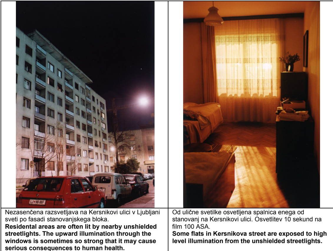
Slika 10: Nezasenčena razsvetljava v Kersnikovi ulici je nazoren primer okolju neprimerne in neprijazne razsvetljave. Razmeroma ozka ulica v kateri prevladujejo etažna stanovanja je osvetljena s svetilkami CX 63 največjih moči. Ker niso zasenčene, osvetljujejo fasade stavb na obeh straneh ulice, pa tudi spalnice v nižje ležečih nadstropjih (slika desno). Razsvetljava Kersnikove ulice je nazoren primer pomanjkanja strokovnega pristopa in vsiljevanja nezaželjene svetlobe.
