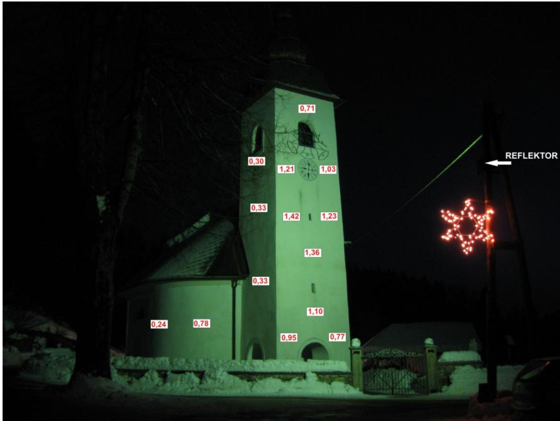
Slika 23: Meritve osvetljenosti na cerkvi Najdenja Sv. Križa
