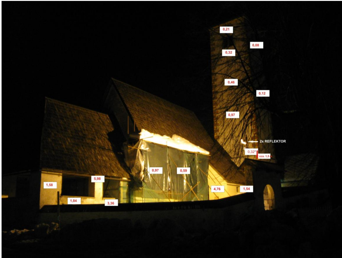
Slika 21: Meritve osvetljenosti na cerkvi Janeza Krstnika v Ribčevem Lazu
